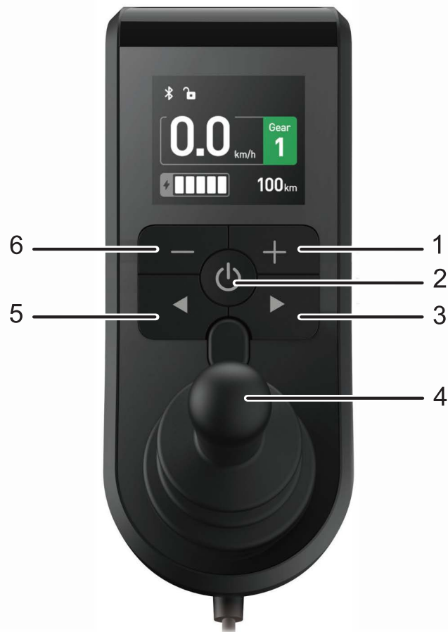
Bild 17: Bedienelemente des Bedienfelds
